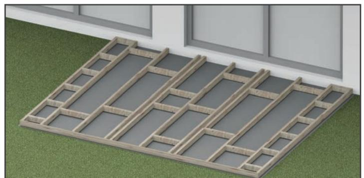
**8.** Alternativ können Sie mit quer eingebauten kurzen Konstruktionshölzern eine stabile und verwindungssteife Konstruktion erstellen.
